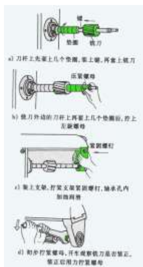
图 2 带孔铣刀的安装
