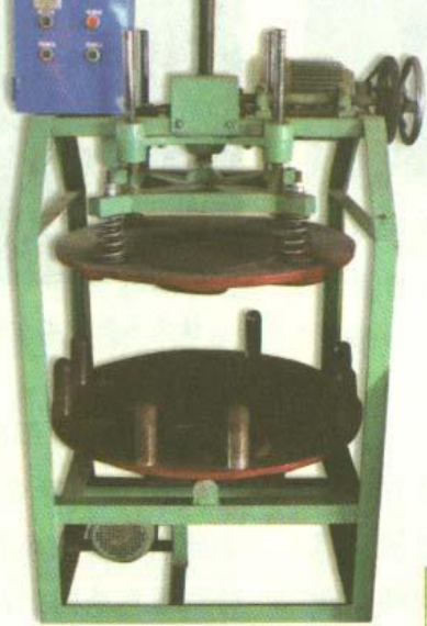
上图：复揉时采用的揉茶机械 下图：复培之后的复包揉工序
